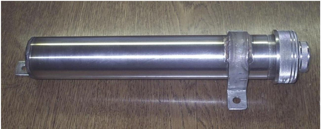
Рис. 1.12. Внешний вид макета регистратора в сборе.
