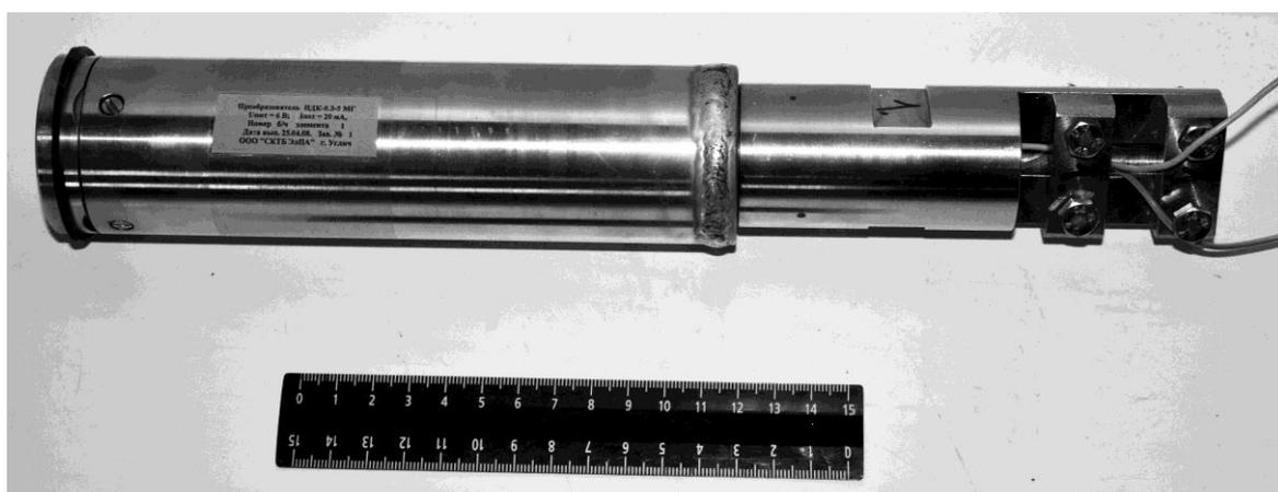
Рис.1.2. Кабельный пьезорезонансный датчик гидростатического давления.
