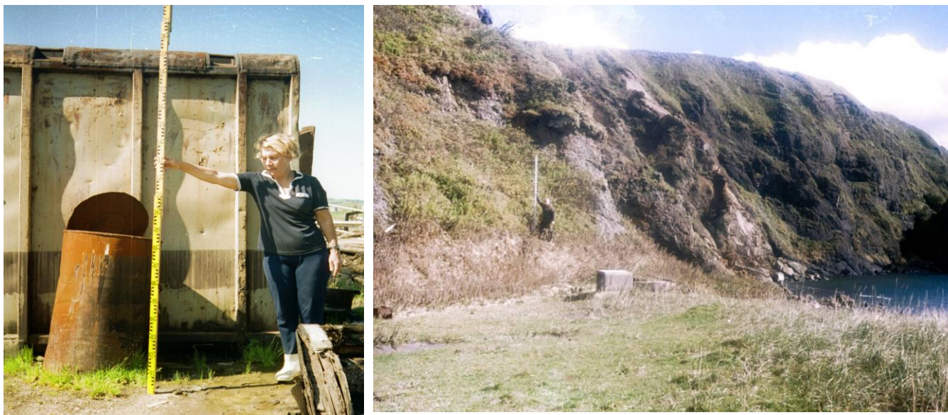
Рисунок 2.2 – Замеры максимальных высот цунами 4 октября 1994 года: слева – по черному следу, оставленному разливом дизтоплива в бухте Малокурильской (о. Шикотан, фото автора), справа – по следу в бухте Маячной (о. Шикотан, фото А. Харламова), образованному границей между зеленой травой и пожухлой вследствие воздействия морской воды
