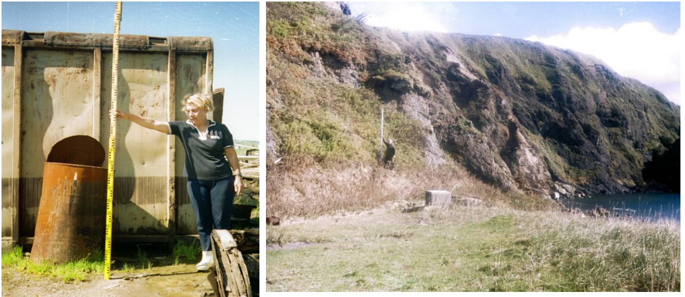
Рисунок 2.2 – Замеры максимальных высот цунами 4 октября 1994 года: слева – по черному следу, оставленному разливом дизтоплива в бухте Малокурильской (о. Шикотан, фото автора), справа – по следу в бухте Маячной (о. Шикотан, фото А. Харламова), образованному границей между зеленой травой и пожухлой вследствие воздействия морской воды
