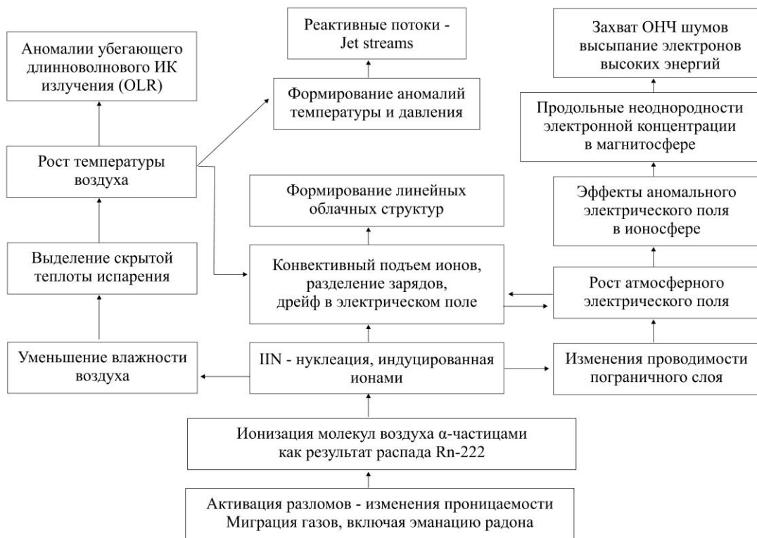
Рисунок 1.5 – Схематическое представление модели комплексных связей в системе литосфера-атмосфера-ионосфера-магнитосфера [Прогноз землетрясений..., 2014]
