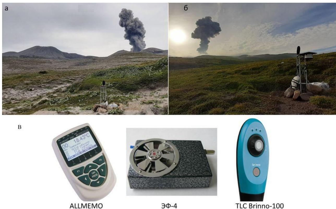
Рисунок 3.26 – а, б – Общий вид расположения ВПН1 и ВПН2 на склоне вулкана Эбеко; в – регистрирующее оборудование: 1 - регистрирующий прибор ALMEMO; 2 – электростатический флюксометр; 3 – камера видеонаблюдения
