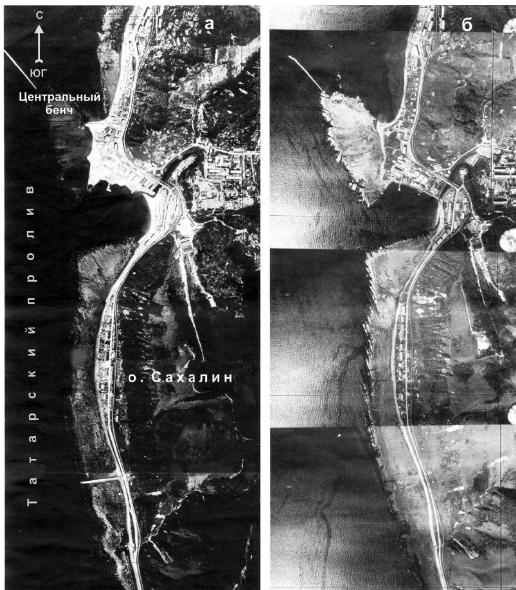
Рис. 8. Аэрофотоснимки южной части Невельска и прилегающей акватории (центральный с волноломом и южный бенчи) до (а) и после землетрясения 02.08.2007 г. (б), любезно предоставленные Ким Ч.У. Песчаная отмель близ устья р. Казачки справа от центрального бенча во время землетрясения видимо была размыва сильным течением стекающей воды.
