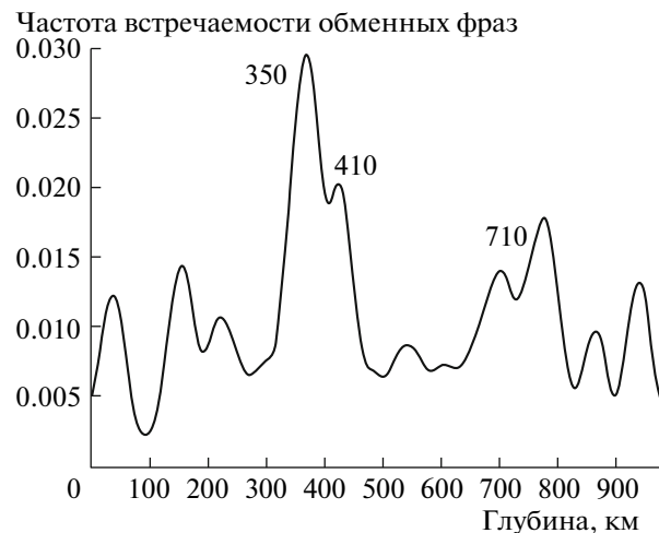
Рис. 3. Гистограмма частоты встречаемости волн PSv [9], построенная с помощью метода [2] и системы GEOSCOPE (окно в пределах 7–60 с, фильтрация через 25 км) по данным станции “станция Инуяма” (Япония).
