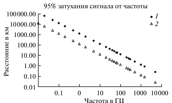
Рис. 7. Зависимость расстояния в км (от источника сигнала), на котором происходит 95% затухание сигнала от частоты для скальных и осадочных пород отдельно при условии плоской волны. Графики даны в двойном логарифмическом масштабе.
