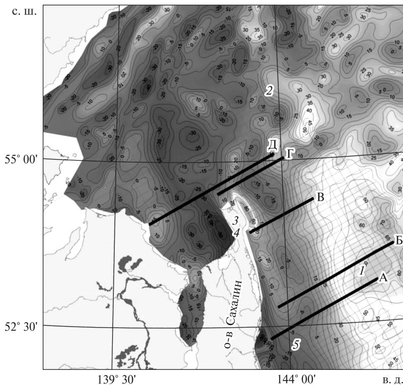
**Рис. 2.** Карта аномального гравитационного поля подводной окраины Северного Сахалина и прилегающей части Охотского моря в редукции Буге (по данным В.А. Зайцева, ДМНГ) с положением профилей МОГТ А-Д (оцифровка изоаномал гравитационного поля условная)
