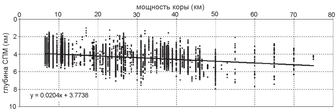
**Рис. 2.** График линейной зависимости глубины СПМ от мощности твёрдой коры, рассчитанный по данным модели CRUST 2.0.
