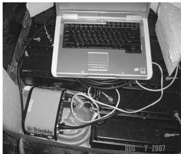
Рис. 3. Автономная GPS станция непрерывной регистрации (о. Матуа): а — пилон с антенной; б — контейнер с GPS приемником и батарейным питанием
