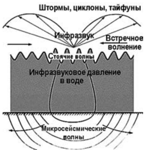
Рис. 4. Комплекс взаимосвязанных явлений в земной коре и в атмосфере и гидросфере, возникающий от стоячих водяных волн, согласно [15]
