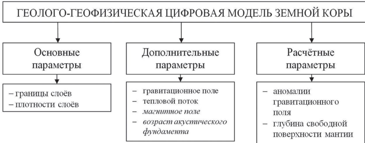
Рис. 4. Структура цифровой модели земной коры Охотоморского региона (курсивом обозначены параметры, находящиеся в стадии разработки)
