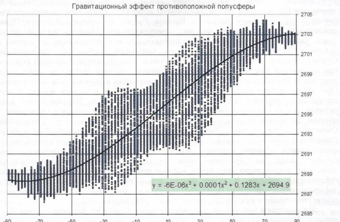
Рис. 1. Рассчитанные значения гравитационного эффекта дальней полусфера Земли (по данным цифровой модели земной коры Crust 2).
